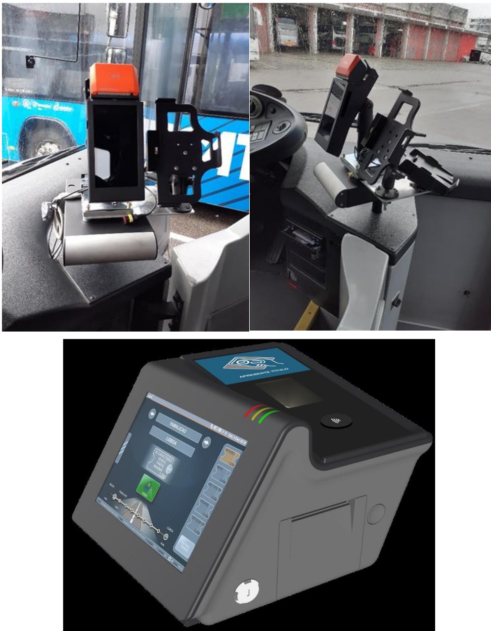
Figura 23 - Sistema de bilhética embarcado AmiNeo instalado nas viaturas a 01/05/2022
